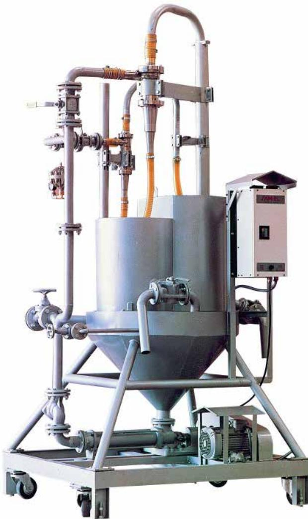
Hem laboratuvar hem de pilot çalışmaya uygun, 7,5 HP, 2800 dev/dak, 380 v, 3 p, 50 Hz elektrik motorlu ve santrifüj tipi basma pompalı
