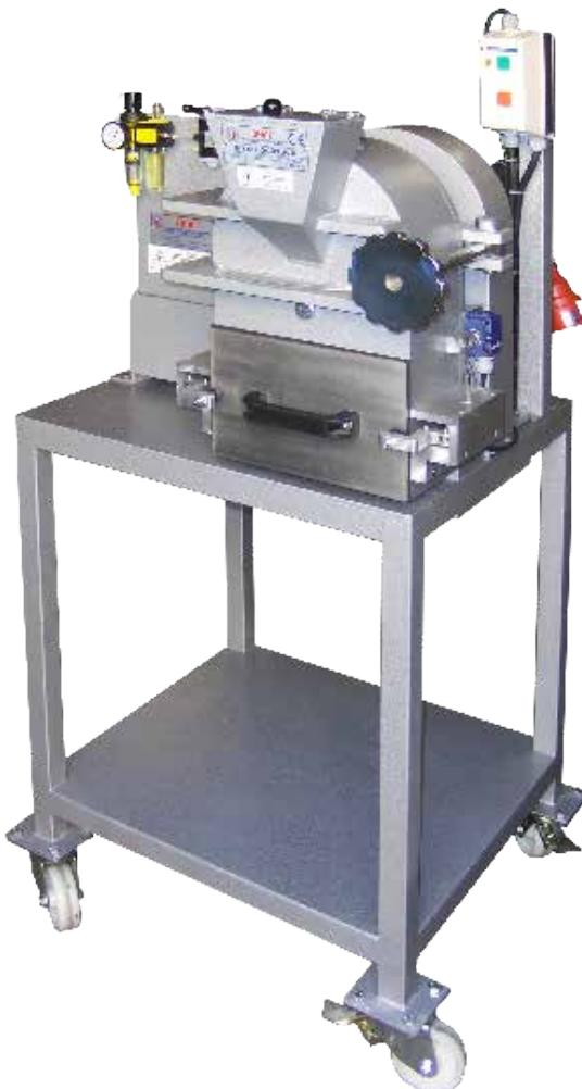
Orta-sert, sert, kırılgan ve zorlu malzemelerin çok hızlı, güvenli ve verimli bir şekilde öğütülmesi için kullanılır. Laboratuvara ve endüstriyel tesislerde numune hazırlama adına oldukça kullanışlıdır. Uygulama Alanları: Alaşımalar, bazalt, çimento klinker, seramik, seramik tozu, kömür, kok kömürü, inşaat malzemeleri, feldspat, cam ve malzemeleri
