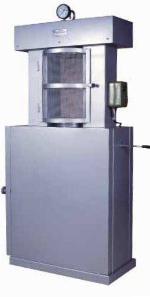
Kompakt ve sağlam tasarımlı, 30 ton max.basma kapasiteli. Presin maksimum basma basıncı aşırı basınç ayarlama valfi ile kolayca ayarlanabilir. Örneğin 5 ton basıncı ayarlanır ise pres maksimum 5 ton basar. 3 kw, 1400 dev/dak, 380v, 3p, 50 Hz elektrik motorlu, hidrolik pompalı ve 20 lt yağ hazneli. Platenler arası düşey açıklık 350 mm Kolonlar arası yatay açıklık 740 mm Hidrolik silindir toplam kursu 200 - 400 mm . Dış ölçüler: 80 x 127 x 215 cm (E X B X Y). Motor korumalı start stop şalterli.
